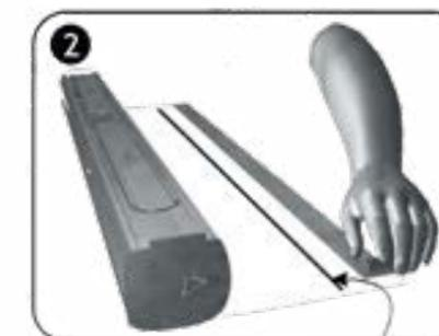
Appoggiare il roll up come nella figura, spellicolare il nastro biadesivo facendovi aderire la stampa (a cui sarà stato precedentemente lasciato un abbondaggio di 6 cm) in corrispondenza della linea nera o grigia stampata sulla parte in plastica
