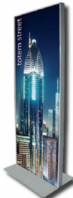
Elegante totem bifacciale in ferro zincato grigio. Composto da una base in spessa lamiera, predisposta per il tassellamento e da un rettangolo per l'inserimento dall'alto di due pannelli (non compresi nel prezzo). Cappello superiore dotato di viti di bloccaggio. Pannelli in pvc 3 o 4 mm (non compresi nella struttura). Colore: grigio. Peso 33 Kg.
