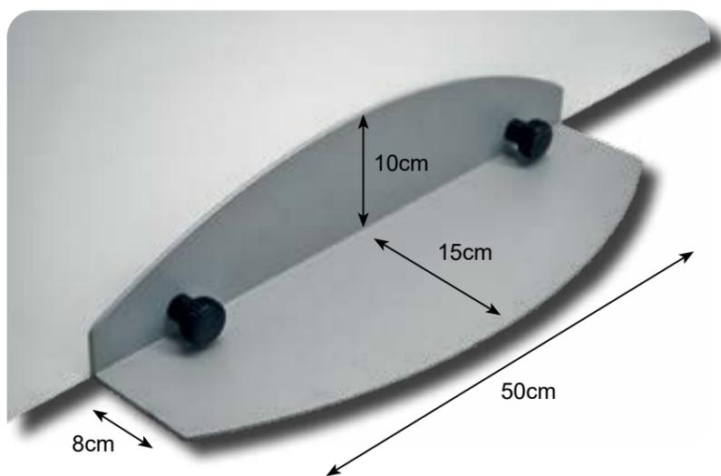
Coppia di mezzelune in lamiera zincata verniciata a polvere epossidica. Finitura nero micalizzato. Pannello non compreso. Ideale per pannelli tipo Sandwich: 10 mm (max H 150 cm) 19 mm (max H 200 cm) Bucare il pannello in corrispondenza dei fori e serrare con gli appositi pomelli filettati comprensivi di viti per il 10 o per il 19 mm. Feltrini adesivi per l'appoggio a pavimento. La mezzaluna copre 10 cm di visibilità della stampa nel punto più alto. Spessore lamiera zincata 1,5 mm. Peso 2,0 Kg.
